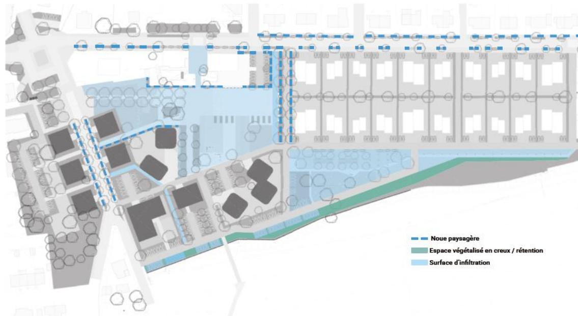
Figure 7: Emplacement des zones d'infiltration
